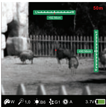
Zdj. 4 Interfejs Regulacji Celownika
